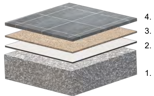
1. betong/asfalt, 2. dränmatta 3. justeringslager 4. marksten/plattor
