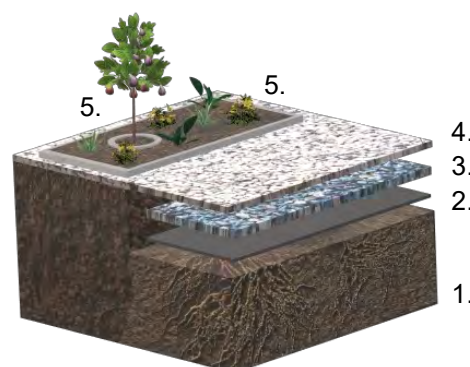
1. undergrund, 2. rotskydd, 3. förstärkningslager, 4. dekorsten, 5. rotbarriär
